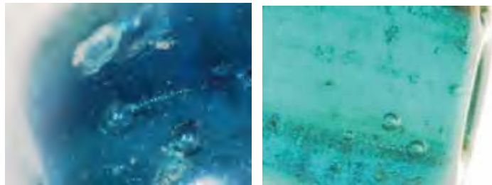
第8図 101号墓出土 高アルミナソーダ石灰ガラスの顕微鏡写真
