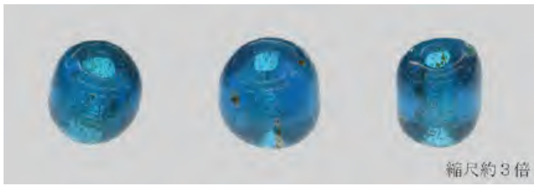
第7図 直径6-7mmの濃青色透明銅着色の高アルミナソーダ石灰ガラス
